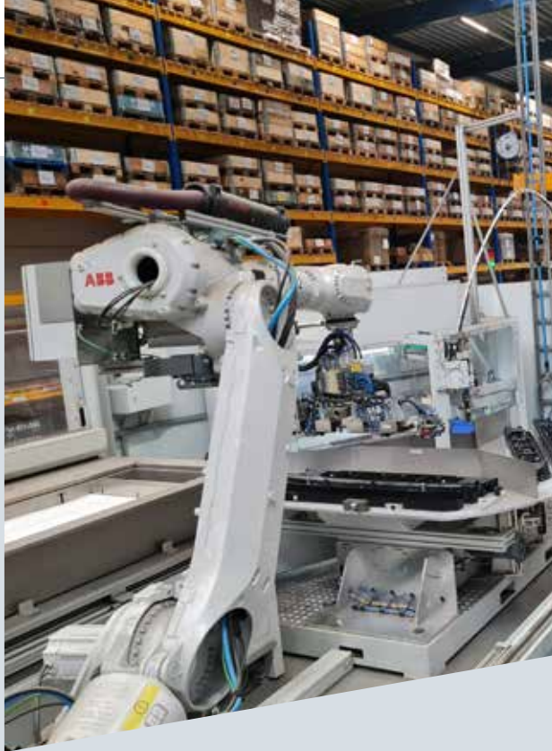
Een IRB 6700 legt de afgemonteerde grilles inclusief tussenlegvellen in een speciaal ontwikkelde krat.
